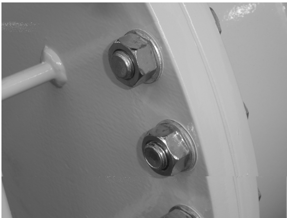
Bild 3.1-2: Verschraubter Deckel auf Mannloch [Büdenbender]
