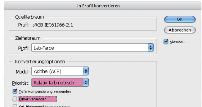
Abbildung 3.7 Der Befehl In Profil konvertieren erlaubt den problemlosen Wechsel zwischen den Farbräumen. Die hervorgehobenen Bereiche sollten gegenüber dem Standard wie dargestellt geändert werden.
