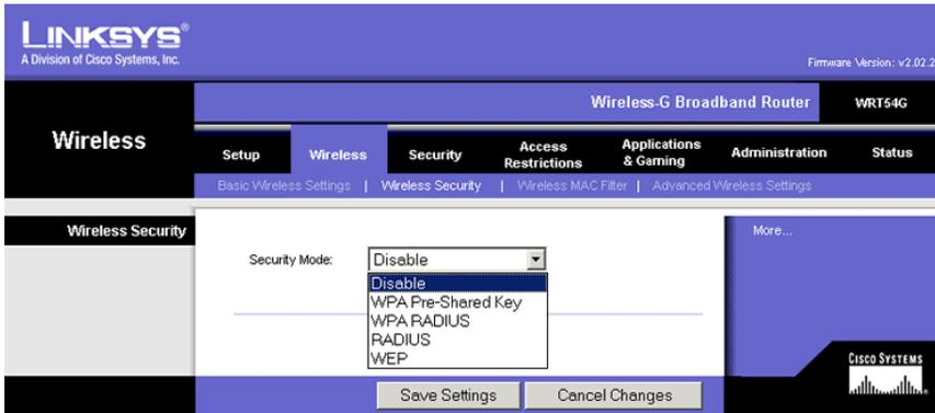
Abbildung 3.47: WPA-Einstellung an einem Access Point
