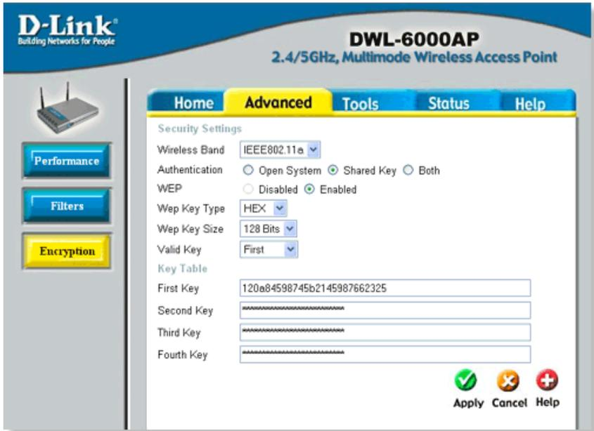
Abbildung 3.42: Einführung eines WEP-Keys
