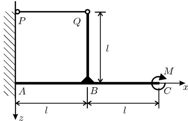
Der Stab ist im Punkt  $P$  an der Wand drehbar gelagert. Im Punkt  $C$  wirkt ein Moment  $M$  auf den Balken. Ohne äußere Belastung ( $M = 0$ ) ist das System vollkommenspannungsfrei. Der Einfluß der Schwerkraft sei vernachlässigbar.
