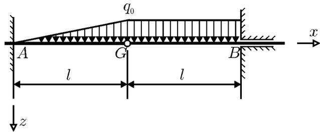
Die Biegesteifigkeit  $EI$  der Balken ist in beiden Bereichen gleich und konstant. Auf den Balken  $\overline{AG}$  wirkt eine lineare Streckenlast  $q(x)$ , die ihren Maximalwert  $q_0$  im Punkt  $G$  hat, und auf den Balken  $\overline{GB}$  eine konstante Streckenlast mit dem Wert  $q_0$ .
