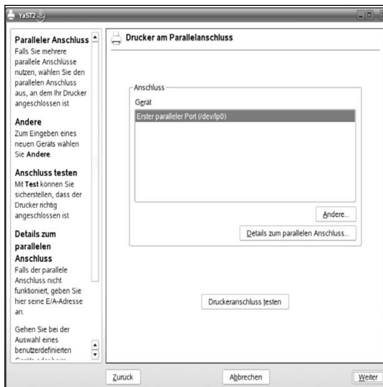
Abbildung 4.10: Die Druckerschnittstelle wird aus der Sicht von LINUX intern als eine Datei angesehen. Die erste parallele Schnittstelle (unter Windows als LPT1 bekannt) heißt in einem LINUX-System /dev/lp0
