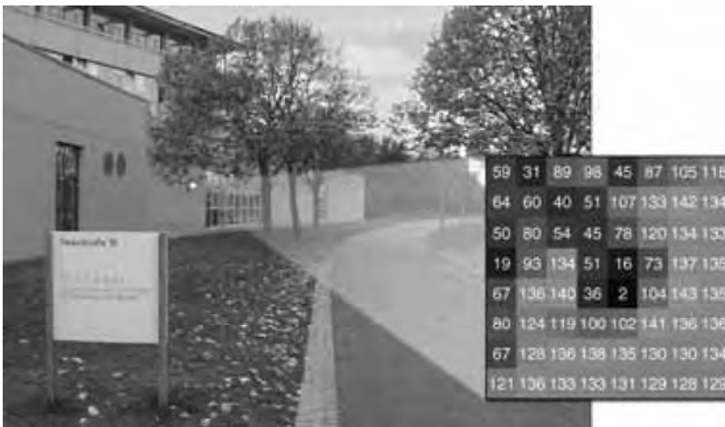
Abb. 1.4: Quadratischer Pixelblock eines Graustufenbildes
