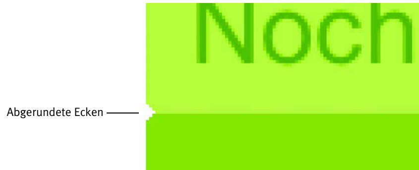
Abbildung 3.9 Die abgerundete Ecke besteht in Wirklichkeit aus ein paar weißen, stufig angeordneten Pixeln, die an jede Ecke der Reihe angesetzt sind.
