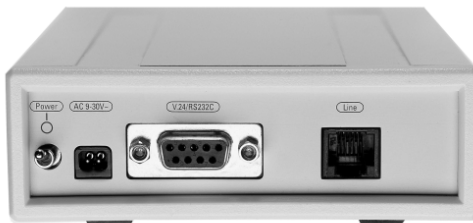
Abbildung 3.14: Anschlüsse eines externen Modems (links: Netzteil, Mitte: serieller Anschluss, rechts: analoger Telefon- anschluss) (Foto: devolo AG)
