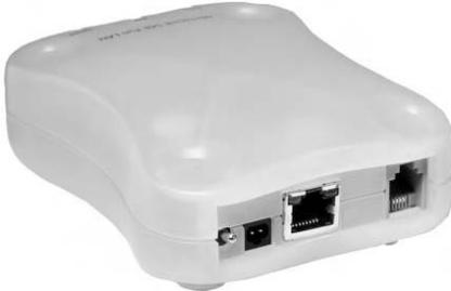
Das Modem MicroLink 56k Fun LAN von devolo ist das erste Modem mit einer eigenen Ethernet-Schnittstelle. Es wird wie ein Computer am Netzwerkrouter mit einem Netzkabel angeschlossen. Braucht ein Computer im Netzwerk eine Internetverbindung, wählt sich das Modem automatisch ein.
