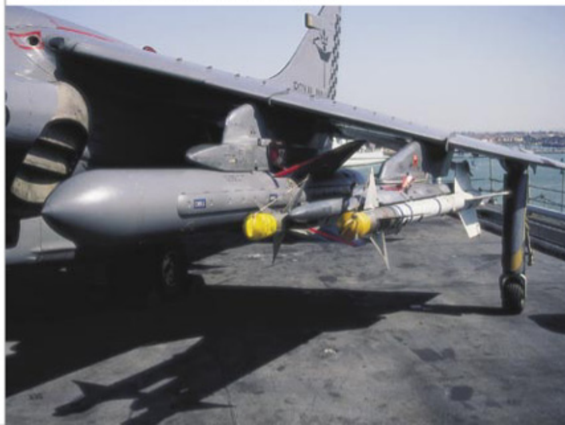
Der Seeziel-Lenkflugkörper Sea Eagle an einer Sea Harrier, die zum Selbstschutz auch noch AIM-9L Sidewinder mitführt.
