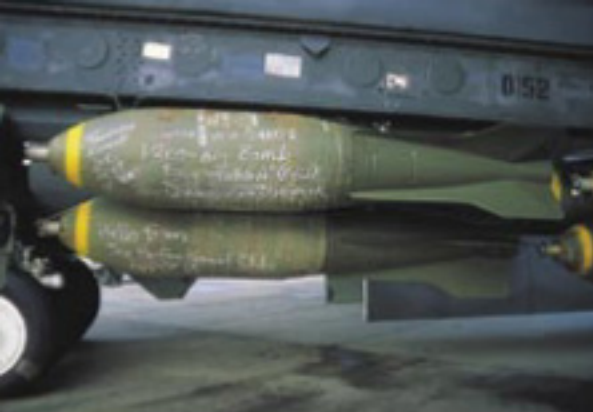
340 kg schwere M117 mit Widerständen an einer B-52G während des ersten Golfkrieges.
