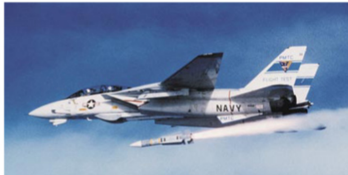
Unten: Eine F-14A Tomcat des PMTC schießt einen Lenkflugkörper des Typs AIM-54 Phoenix ab.
