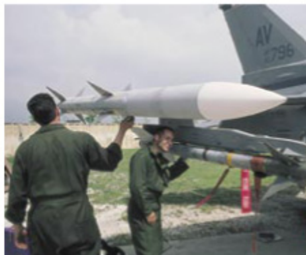
Bodenpersonal der USAF überprüft eine AIM-120 AMRAAM und eine AIM-9M Sidewinder an einer F-16 Fighting Falcon vom US-Jagdgeschwader 31 auf dem italienischen Fliegerhorst Aviano vor einem bewaffneten Sperrflug über dem ehemaligen Jugoslawien.
