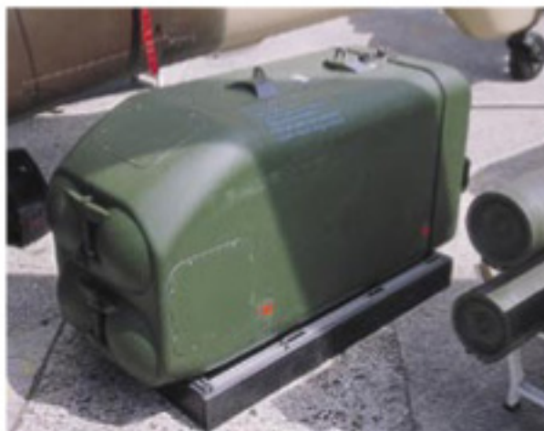
Rechts: Ein Vierfach-Startgerät für den Panzerabwehr-Lenkflugkörper TRIGAT.
