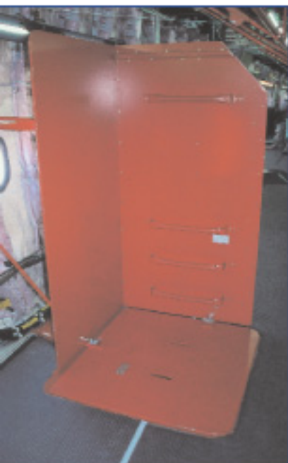
Die Luke zum Notabstiegschacht ist nur in MSN001 und MSN004 eingebaut.
