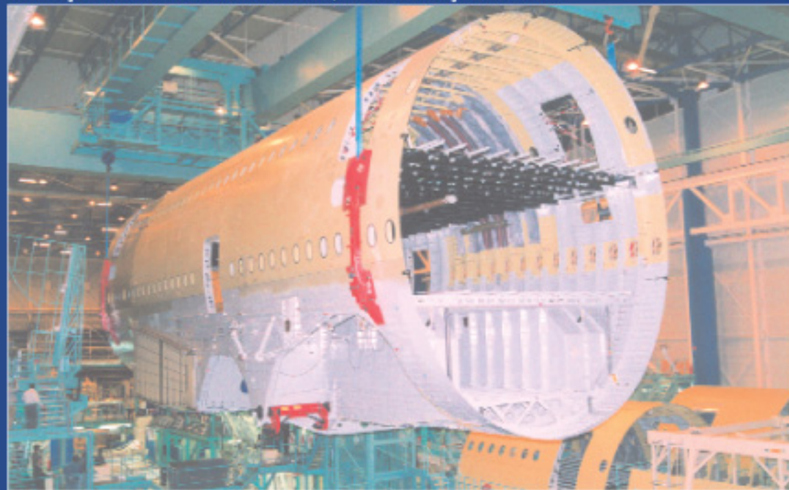
Die Querträger des oberen Fußbodens bestehen aus Kohlefaser, wie auf diesem Foto gut zu erkennen ist.
