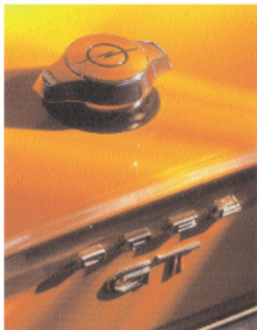
Hinter dem Opel-Emblem ist das Schloss des Tankdeckels versteckt.
