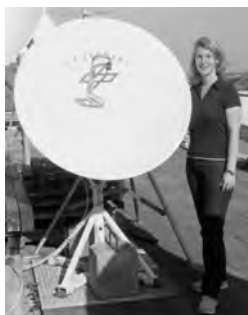
Abb. 8.1 Ein Very Small Aperture Terminal (VSAT) bzw. Satellite Interactive Terminal (SIT)
