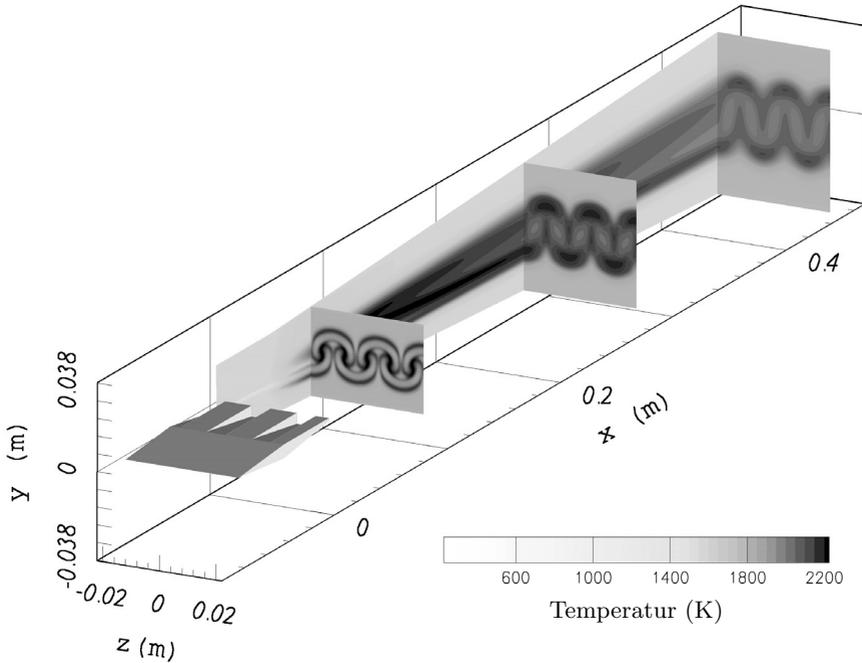
**Abb. 1.1.** Berechnete Temperaturverteilung in einer Mach 2 Überschallbrennkammer. Gasförmiger Wasserstoff wird durch die wellenförmige Hinterkante des Zentralkörpers in eine Luftströmung eingeblasen
