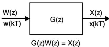
**Abb. 1.87.** Blockschaltbild eines zeitdiskreten Systems
