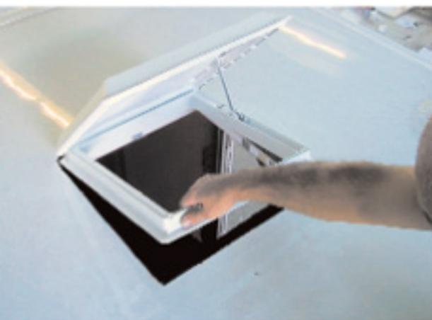
Die neue Luke wird am Montagerahmen umlaufend mit einer Raupe aus Dichtmasse versehen und in die gereinigte Öffnung eingesetzt, dann verschraubt.
