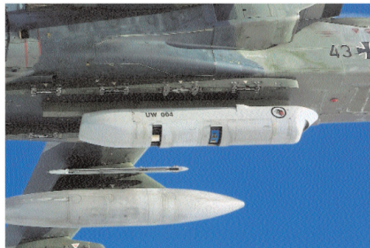
Augen auf: Bei dieser Aufklärungsmission eines AG 51 Tornados sind alle Jalousien geöffnet und die entsprechenden Kameras aktiv.
