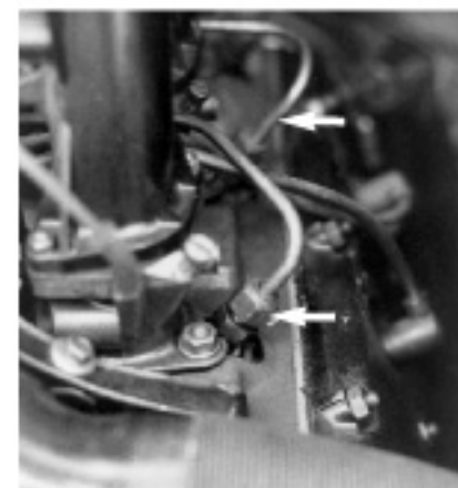
Abb. 156: Mechanisches Einspritzventil, A: Einbauposition, B: Ausgebaut.
