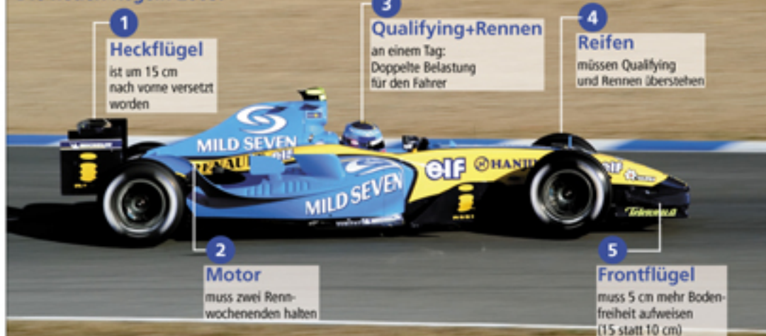
■ Durch die Änderungen soll der Abtrieb der Wagen um 20 bis 30 Prozent verringert und die Geschwindigkeit reduziert werden
