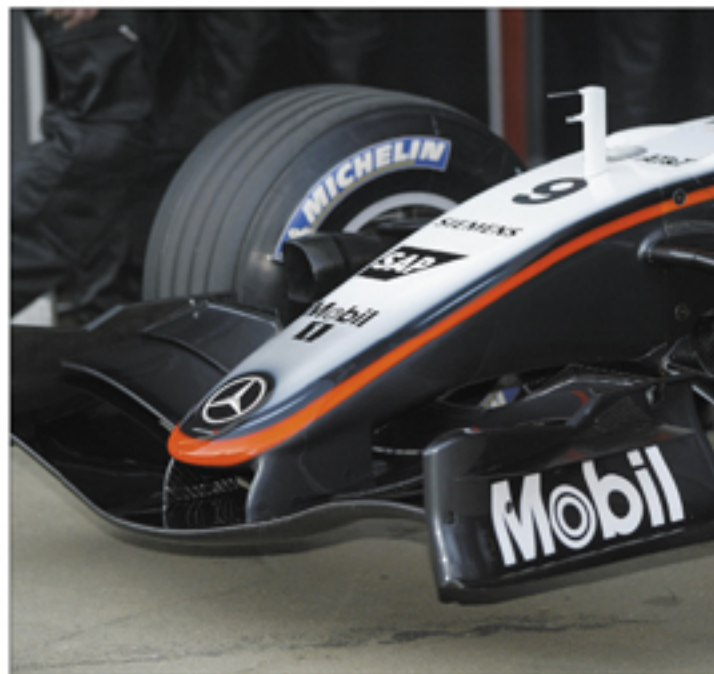
■ Hochnäsig: Der Frontflügel wird um fünf Zentimeter angehoben
