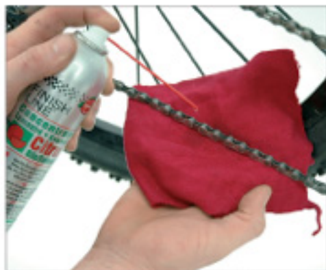
Behandeln der Kette mit Kettenreiniger
