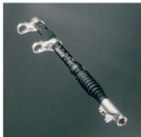
Cannondales Lefty – eine besonders eigenwillige Interpretation des Themas Teleskop-Federgabel aus Carbon
