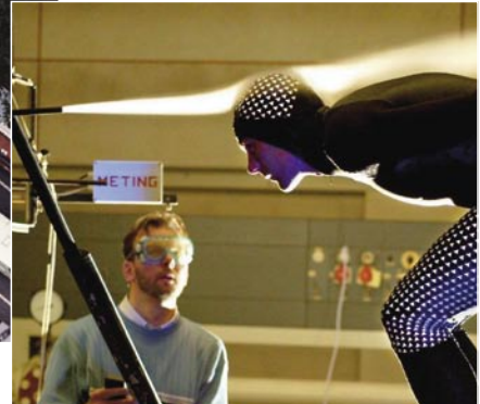
3 Den Strömungswiderstand untersucht man im Luftstrom.
