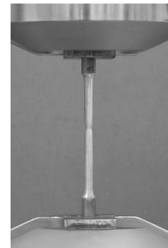
Typisches Einschnürmuster, das sich an diesem Stahlprobekörper kurz vor dem Bruch ausbildete.
