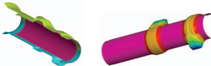
Abb. 3.67. Simulation zur Bewertung der Machbarkeit der Leichtbau-Nockenwelle
