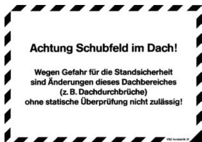
Bild 5-5 Kennzeichnung eines Schubfelds mit einem Aufkleber an der Dachunterseite
