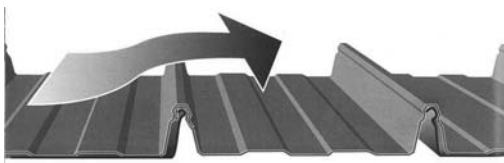
Bild 5-44 Lichtband vom First zur Traufe – a) in Spannrichtung, firstseitiger Anschluss, b) quer zur Spannrichtung
