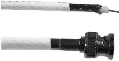
Abbildung 3.3: Koaxialkabel (Thinnet)
