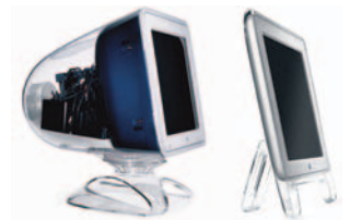
CRT und TFT im Vergleich Fotos: Apple
