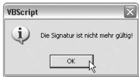
Abbildung 9.12 Diese Meldung zeigt das Skript an, wenn ein signiertes Skript nachträglich geändert wurde
