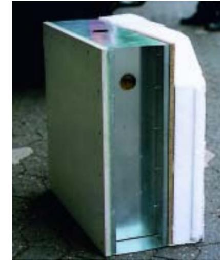
Ganz links oben und links: Ein typischer Wandaufbau mit Blechprofilkonstruktion: innere Beplankung, meist ein oder zwei Lagen Gipskarton; Dampfsper- und Luftdichtheitsschicht; Blechständerwerk 150 Millimeter mit Zwischendämmung; äußere Beplankung (Spanplatte); Wärmedämmverbundsystem
