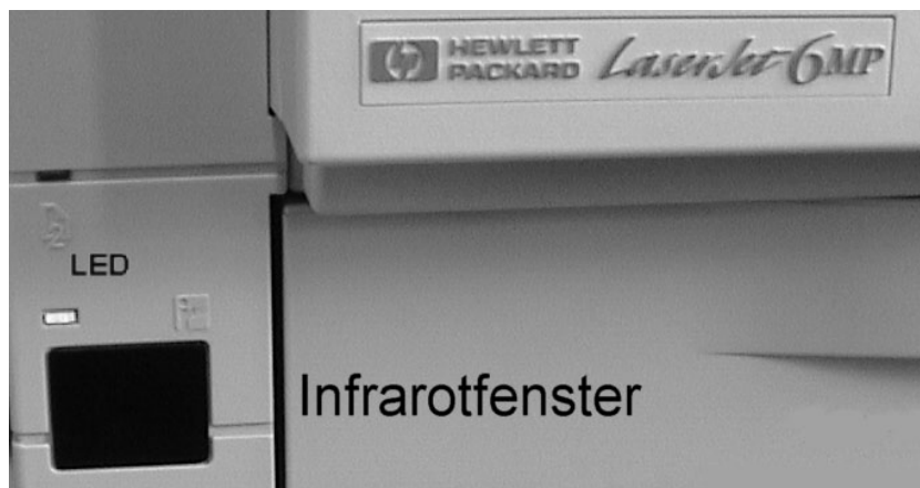
Bild 3.1: Das Infrarotfenster bei einem Drucker. Es ist hilfreich, wenn wie hier, eine Leuchtdiode (LED) die Kontaktaufnahme signalisieren kann.
