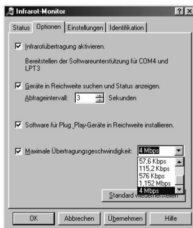
Bild 3.4: Der Infrarot-Monitor in der Systemsteuerung erlaubt die Festlegung der maximalen Übertragungsgeschwindigkeit.
