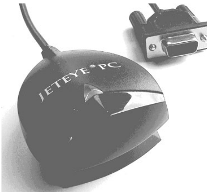
Bild 3.3: Ein externer Infrarot-Adapter, der einfach an einen COM-Port anzuschließen ist
