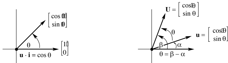
Abb. 1.8. Das Skalarprodukt von Einheitsvektoren ist der Kosinus des Winkels \theta .
