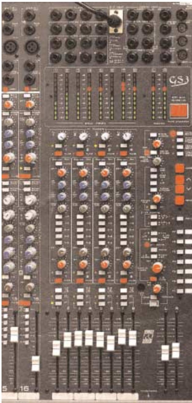
Analoges Mischpult mit Schiebereglern, Knöpfen und Tasten. Die Abbildung rechts zeigt die Software "Reason", deren grafische Oberfläche alle analogen Bewegungen simuliert, wie sie von Hardware-Racks mit ähnlichen Funktionen her gewohnt sind. Darüber hinaus ist sie modular aufgebaut und damit je nach Bedarf Synthesizer, Sequenzer, Sampler u.a.m. oder auch alles auf einmal; die Komponenten werden einfach eingeblendet. Die einzige Limitierung ist die Rechenleistung des Computers.
