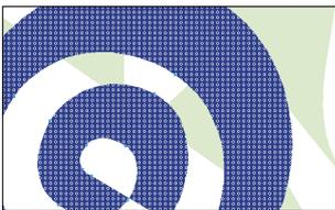
Die Funktion **EINSTELLUNGEN: NEUAUFBAU: ÜBERDRUCKENDE OBJEKTE ANZEIGEN** erstellt am Monitor in überdruckenden Konturen oder Füllungen weiße Kringel. Damit lassen sich auf einen Blick überdruckende Elemente erkennen und die Endkontrolle wird vereinfacht. Die entstehenden Mischfarben sind allerdings optisch nicht erkennbar. Schrift und Bilder zeigen die Kringel nicht.
