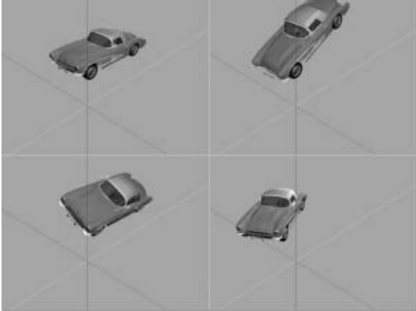
▲ Abbildung 16 Jeweils Drehung um die globale X-, Y- und Z-Achse
