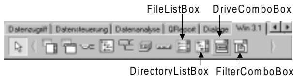
Abbildung 3.4: Die Position der Komponenten auf der Palette
