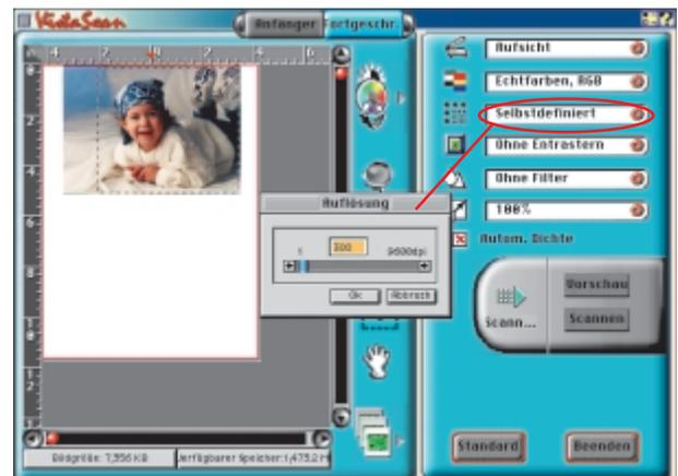
▲ Wenn wie im Fall dieser einfachen Scansoftware lediglich die Scanauflösung eingestellt werden kann, muss sie mit dem weiter vorne beschriebenen Verfahren in Photoshop ermittelt werden. Oder es wird einfach mit der optischen Auflösung gescannt und die Datei anschließend in Photoshop auf die gewünschte Größe gebracht (VistaScan).
