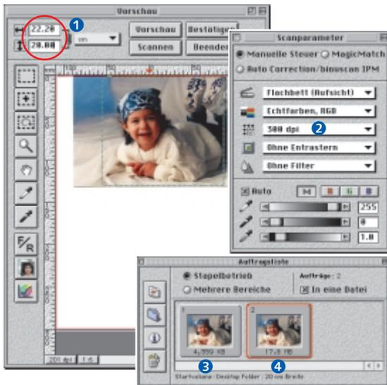
▲ Besitzt die Scansoftware keine separaten Eingabefelder für die Ausgabeabmessungen, bewirkt die Änderung von **Höhe** und **Breite** eine Umrechnung der Eingabewerte in Ausgabewerte (Skalierung) (1) mit der vorgegebenen Auflösung (2). Die Auftragsliste dieses Programms zeigt die Dateigrößen der resultierenden Datei bei Scanbreiten von 10 cm (3) und 20 cm (4) (MagicScan).
