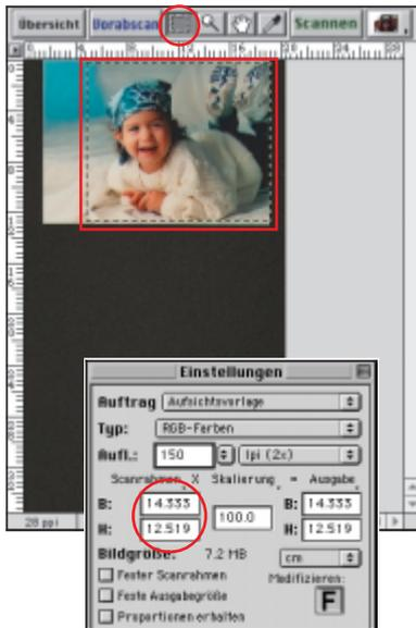
◀ Auf dem Tablet der Scansoftware markiert der Scanner-Operator mit dem **Auswahlwerkzeug** den zu scannenden Bereich. Dessen Abmessungen überträgt die Software automatisch in die entsprechenden Eingabefelder (ScanWizard).
