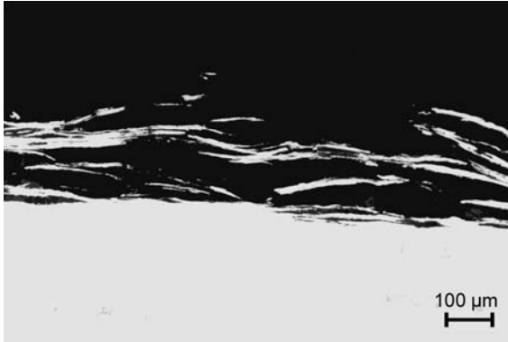
Bild 5.4.6 Beispiel für Schichtkorrosion bei AlZn4,5Mg1 im kaltausgehärteten Zustand (EN AW-7020-T4). Vermeidbar durch Warmaushärtung. Längsschliff ungeätzt (Quelle: Hydro Aluminium Deutschland GmbH (vorm. VAW AG))
