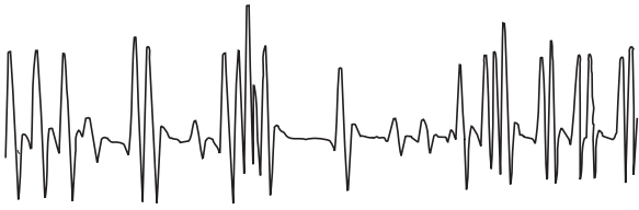
Abb. 10.25. Moduliertes Sättigungsspektrum des Überganges B^3\Pi_u(v' = 58, J' = 11) \leftarrow X^1\Sigma_g^+(v'' = 1, J'' = 98) im J_2 -Molekül mit spektral aufgelöster Hyperfeinstruktur
