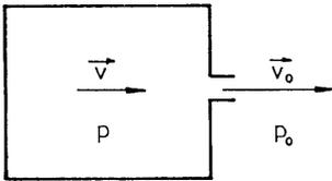
Sind  $A$  und  $A_0$  die Querschnitte des Behälters und der Austrittsöffnung, dann ergibt sich, wie im vorangehenden Beispiel, für  $v_0$  die der Formel (5.6) entsprechende Beziehung:
