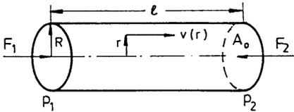
Abb. 5.7. Verhältnisse bei einer Rohrströmung
