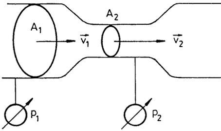
Abb. 5.4. Strömung durch eine Rohr-Verengung
