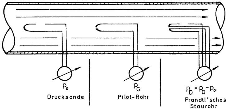
Abb. 5.3. Sonden zur Druckmessung in Strömungen
