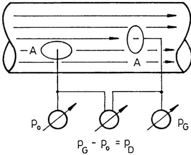
Abb. 5.2. Druckmessung in Strömungen
