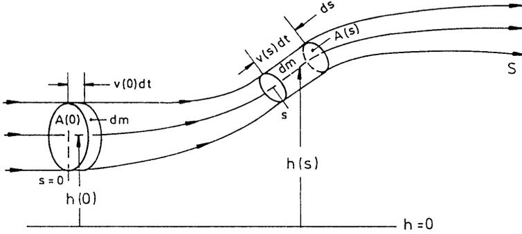
Abb. 5.1. Bewegung eines Volumenelements in einer Stromröhre
