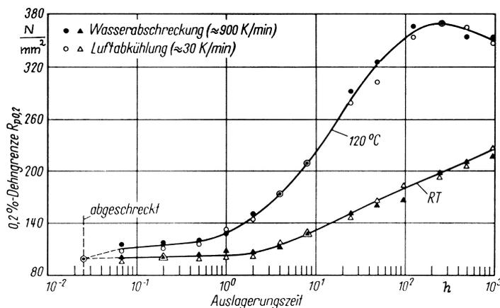
**Bild 8-7.** Streckgrenzenenerhöhung des aushärtbaren Aluminiumwerkstoffes AlZnMg 1 bei Warm- und Kaltauslagern [8-2].
