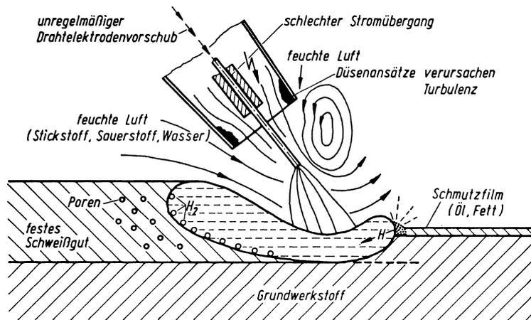
**Bild 8-17.** Mögliche Wasserstoffquellen beim MSG-Schweißen von Aluminiumwerkstoffen [8-8].
