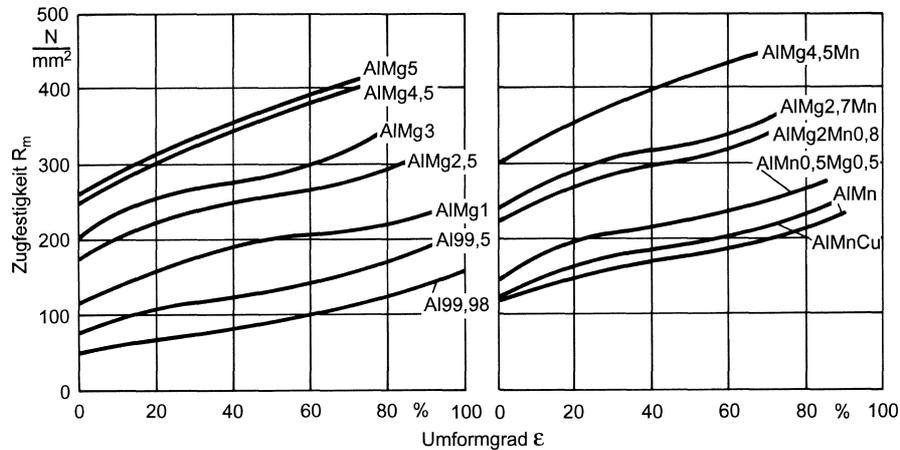
**Bild 8-10.** Kaltverfestigung von Aluminiumwerkstoffen in Abhängigkeit vom Umformgrad [8-1].
