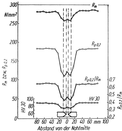
**Bild 8-12.** Härte- und Festigkeitsabfall in der WEZ einer kaltverfestigten Aluminiumlegierung.
