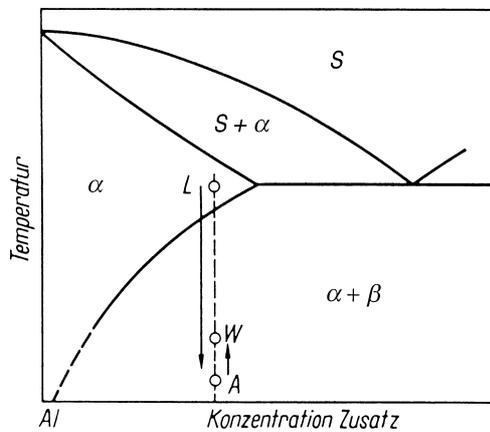
**Bild 8-4.** Binäres System eines aushärtbaren Aluminiumwerkstoffes und zugehörige Wärmebehandlung zur Aushärtung [8-2].
