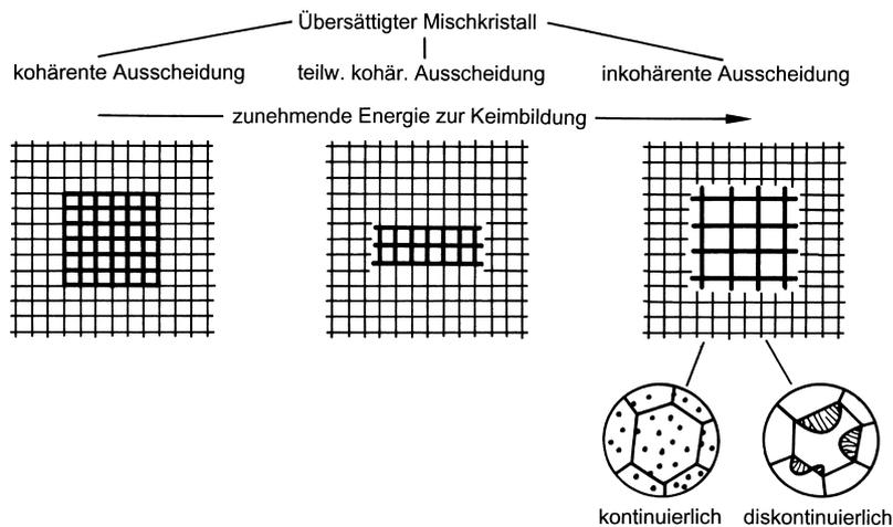
**Bild 8-5.** Ausscheidungsformen eines übersättigten Aluminium-Mischkristalls. Aus: Böhm H.: Einführung in die Metallkunde. B.I.-Hochschultaschenbücher. Band 196. Mannheim 1968, S. 194.
