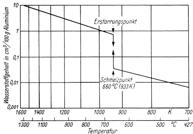
**Bild 8-16.** Löslichkeit von Wasserstoff in Aluminium [8-8].
