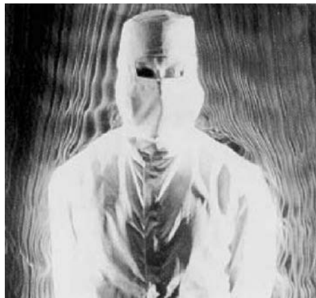
Bild F2-36 Umströmung einer Person in laminarer Verdrängungsströmung
