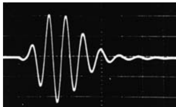
Abb. 1.4 Ultraschallpuls (2,24 MHz). Druck auf der y-Achse, Zeit auf der x-Achse (zwei Kästchen entsprechen 1 µs) (Quelle: 20).
