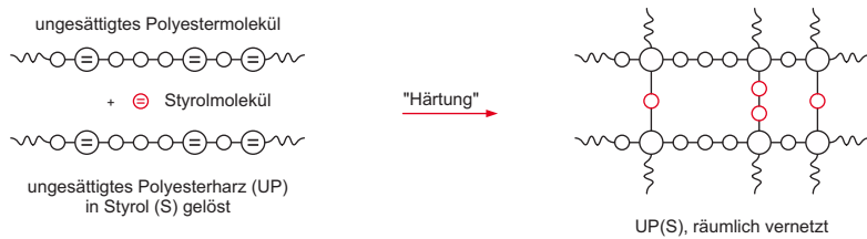
Bild 2.14: Reaktionsablauf beim „Aushärten“ eines UP (schematisch)
