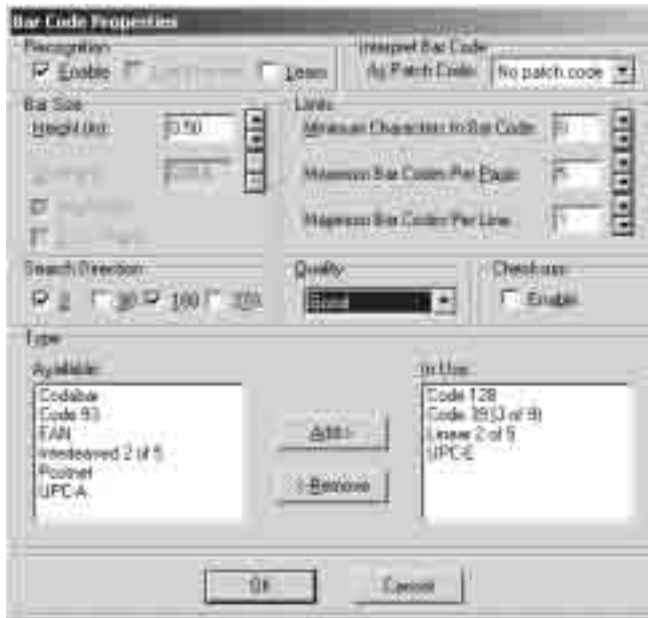
Abb. 2-7 Konfigurieren der Barcode-Erkennung (Quelle: FileNet)
